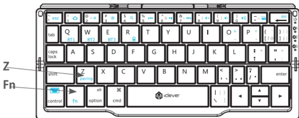
ステップ 4: お使いのデバイスの Bluetooth 機能を有効にし、接続可能なデバイスを探します。検索画面に「iClever IC-BK11 Keyboard」が表示されたら、クリックして接続します。
