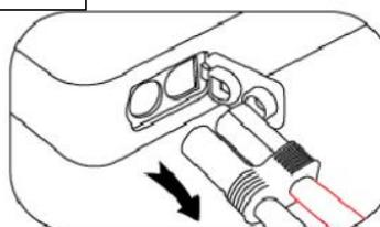
エンジンが始動したらジャンプスターターケーブルのプラグを持ち本体から抜いてください。**車載バッテリーから黒色クリップ→赤色クリップの順で外**してください。
