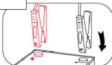
ジャンプスタートケーブルの**赤色クリップを車載バッテリーの (+) 端子に接続して、黒色クリップを車載バッテリーの (-) 端子に接続**してください。インジケータが緑色で常時点灯すると、次のステップに進んでください。それ以外の色で点灯する場合、「ご注意」の説明部分を参考して処理してください。
